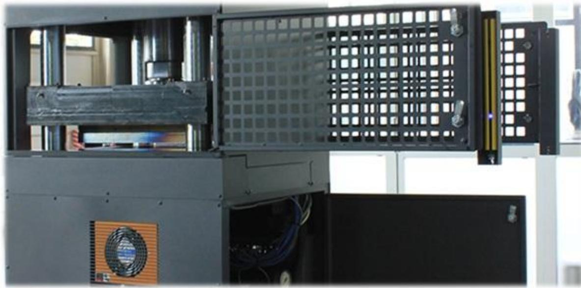
Las tapas abatibles y la amplia separación entre columnas de nuestras máquinas facilitan la colocación y extracción de los moldes. La unidad hidráulica y el panel eléctrico son fácilmente accesibles abriendo las tapas. Para el servicio y el mantenimiento, las placas de servicio fácilmente desmontables permiten acceder a cualquier punto en cuestión de minutos.
